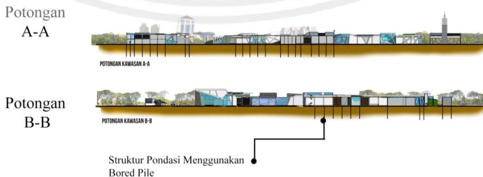
Gambar. 7.6. Potongan Kawasan (Sumber : hasil Perancangan, 2017)
