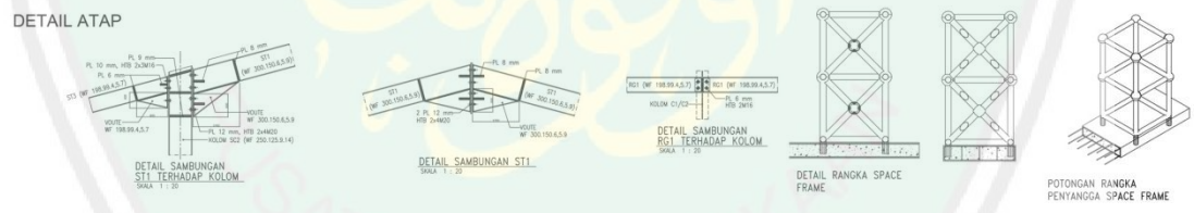
Gambar. 7.73. Detail Struktur Atap (Sumber : hasil Perancangan, 2017)
