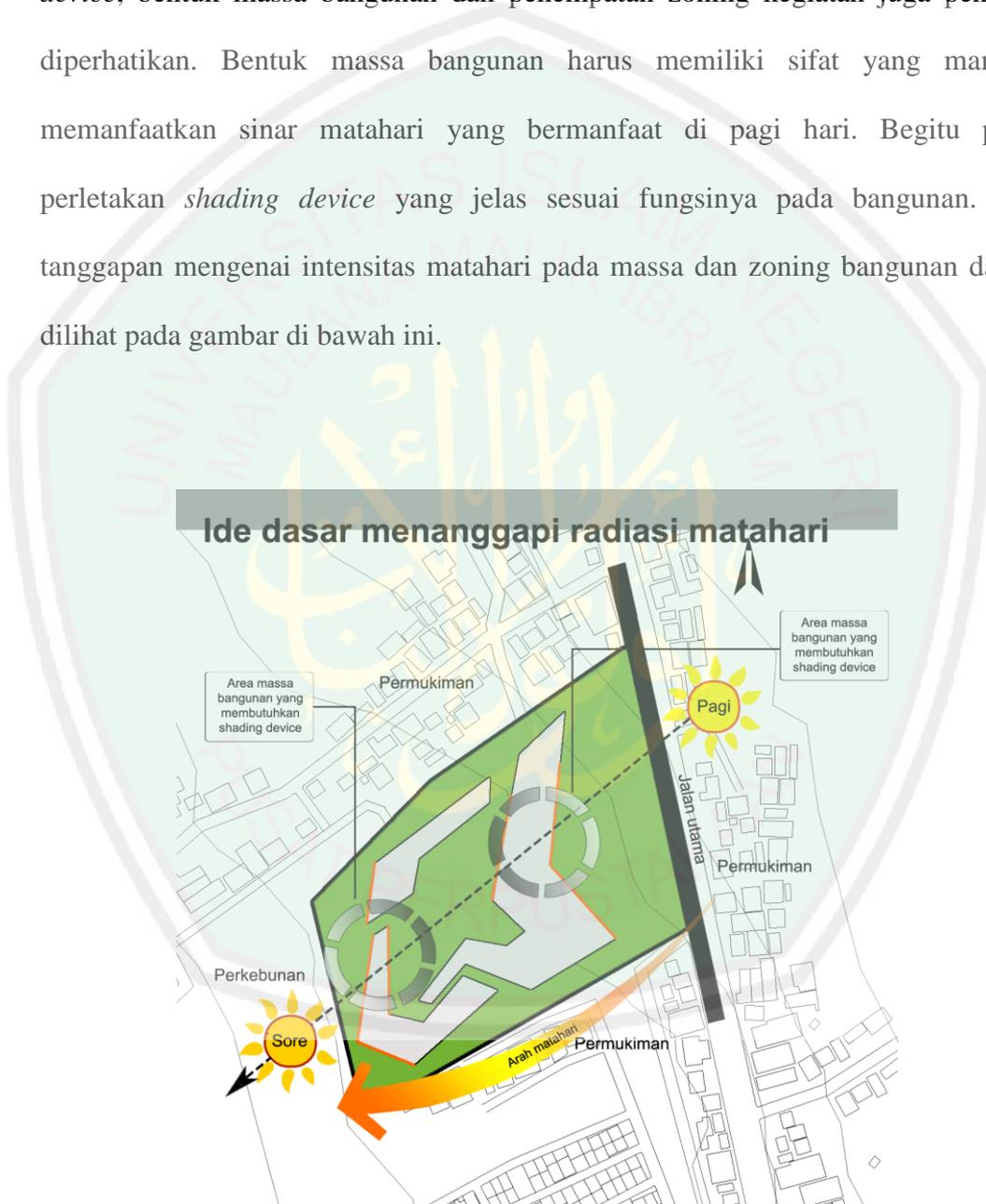
**Gambar 5. 20 Ide Dasar Menanggapi Radiasi Sinar Matahari dengan Menghasilkan Kebutuhan Perletakan *Shading***
