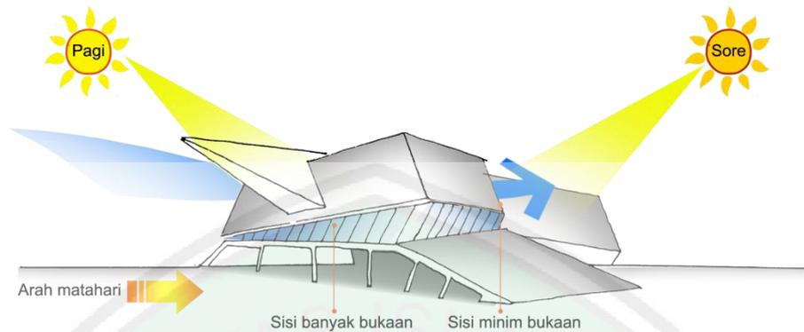
**Gambar 5. 21 Kondisi Eksisting Pergerakan Matahari pada Tapak (Analisis, 2016)**
