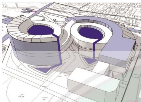
Rain Water Harvesting pada atap bangunan utama yang disalurkan melalui jalur green roof.
