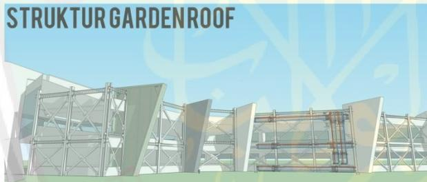
Struktur gerbrette ini merupakan komponen baja cetak, tidak ada proses lain yang dapat menghasilkan elemen baja dengan ukuran dan bentuk seperti ini. pabrikasi yang berguna untuk memperkuat atau memperkencang bagian antar kolom. karena bangunan yang memiliki ketinggian ekstrim sehingga menggunakan struktur ini. struktur ini sangat mengutamakan teknologi tinggi (sumber : angus j. mcdonald)
