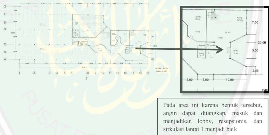
Gambar 7.16 Denah Lantai 1 Gedung Kantor
