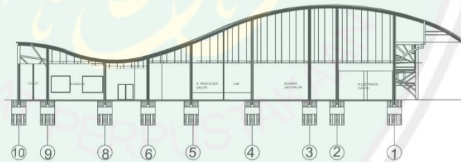
Gambar 7.42 Struktur Pondasi Gedung Pabrik
