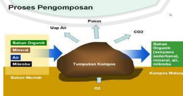
Gambar 2.7 Proses Umum Pengomposan Limbah Padat Organik (dimodifikasi dari Rynk, 1992)
