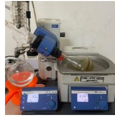
Evaporasi filtrat hasil maserasi 1 x 24 jam
