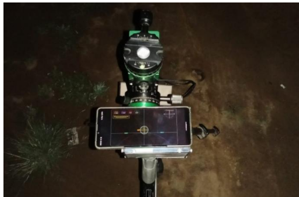
Gambar 3. 13 Peletakan ponsel dalam proses kalibrasi level
