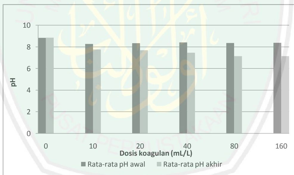
Gambar 4.7 Grafik hubungan pH dan dosis koagulan pada larutan Nitrat 14 ppm.
