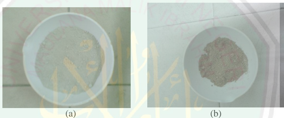
Gambar 4.2 Hasil aktivasi zeolit (a) zeolit sebelum aktivasi (b) zeolit setelah kalsinasi.
