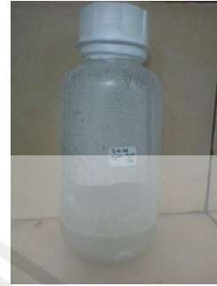
Gambar 14. Hasil zeolit setelah perlakuan hidrotermal
