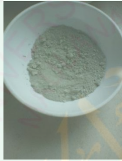
Gambar 15. \text{TiO}_2 -zeolit sebelum kalsinasi
