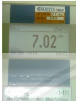
Gambar 6. Pengukuran pH netral dengan pH meter
