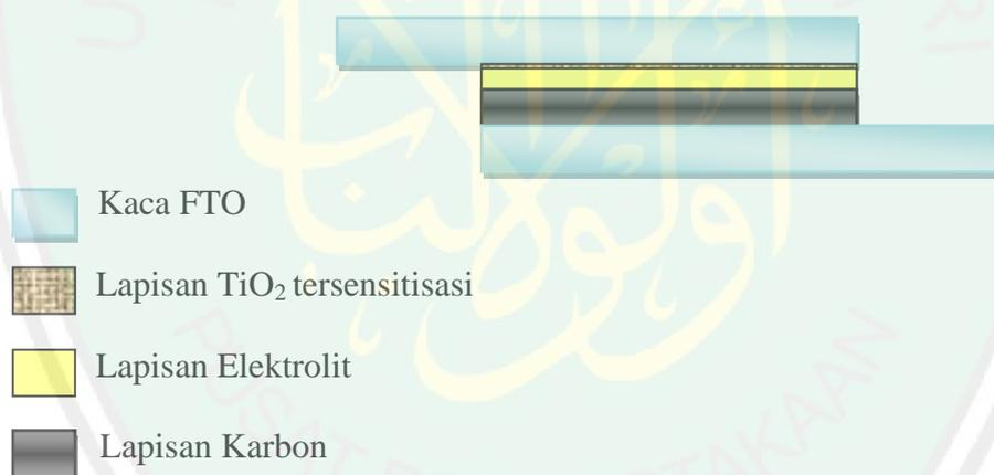
Gambar 4.9 Lapisan pada SSPT
