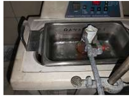
Proses sonikasi menggunakan waterbath
