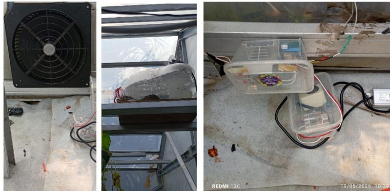
Gambar 4. 3 Implementasi Aktuator Intake Fan dan Humidifier
