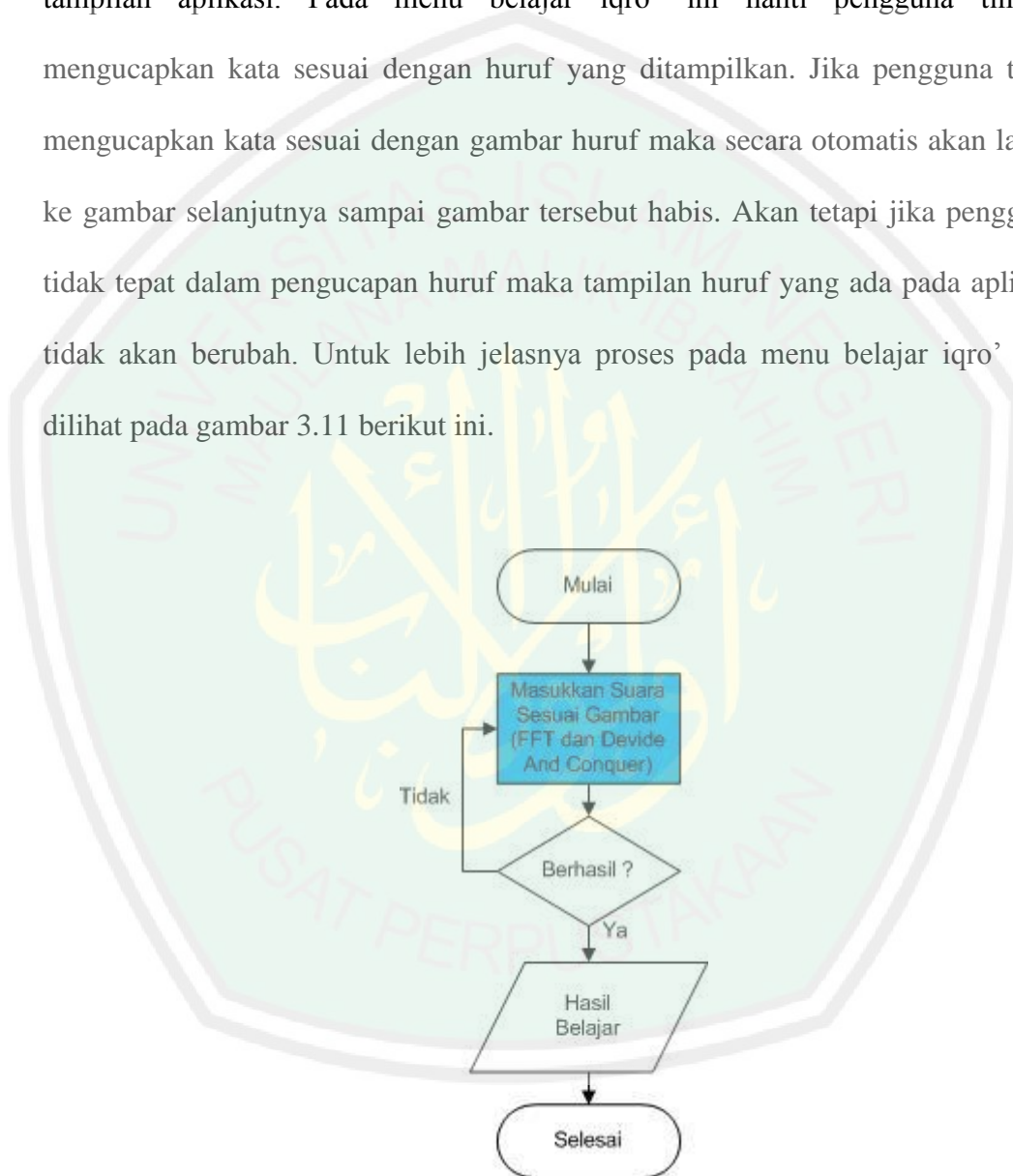
Gambar 3.11. Flowchart pencocokan suara pada menu belajar
