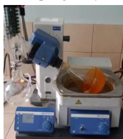
Pemekatan ekstrak menggunakan rotary evaporator
