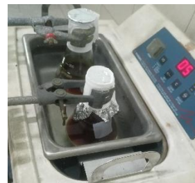
Pembuatan ekstrak dengan Ultrasound Water Bath
