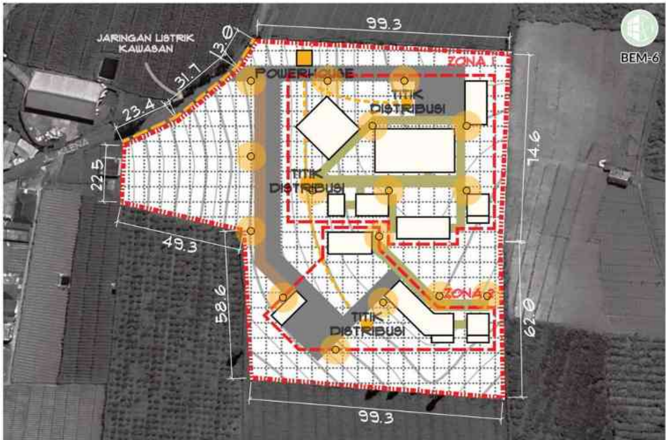
Gambar. 2.38. Skema sistem distribusi listrik pada kawasan.
