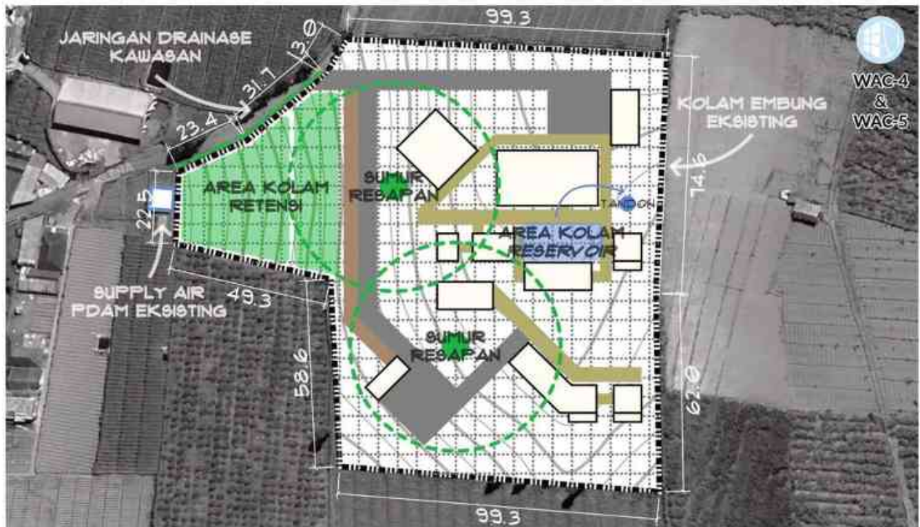
Gambar. 2.41. Skema sistem distribusi air bersih dan air kotor pada kawasan.
