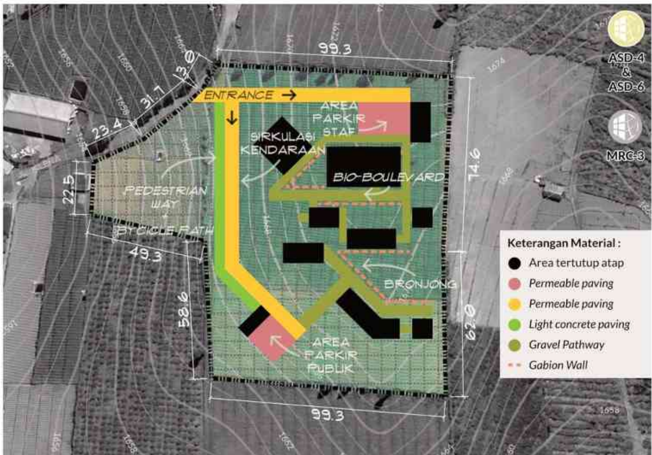
Gambar. 2.29. Skema implementasi material perkerasan pada tapak.
