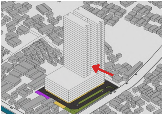
5. Tower sisi selatan dimundurkan ke barat, menghindari bentuk bulky , pada bangunan, sekaligus memberi akses outdoor pada rooftop
