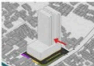
5. Tower sisi selatan demundurkan ke barat, menghindari bentuk bulky, pada bangunan, sekaligus memberi akses outdoor pada rooftop
