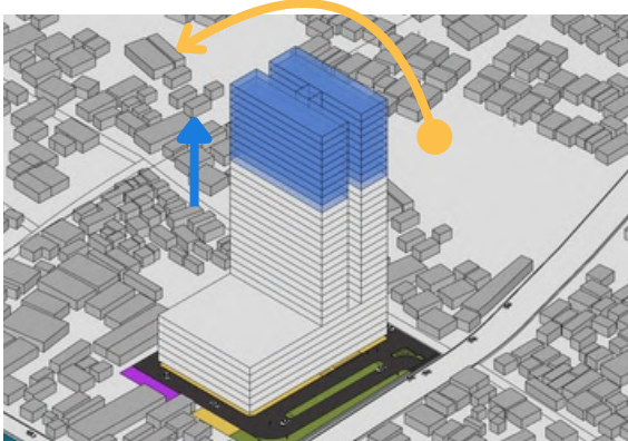
3. Untuk ruang yang efisien, tower membentuk huruf H , dengan core sebagai penghubung di tengah, menambah ketersediaan KLB max, jumlah lantai pada tower dapat ditinggikan. Tower berorientasi panjang dari timur ke barat (respon jalur matahari)
