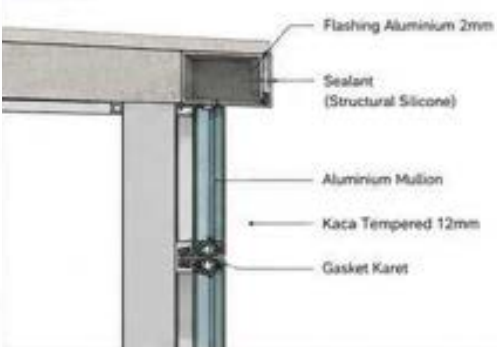
DETAIL SAMBUNGAN ATAP
