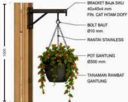
DETAIL PLANTER GANTUNG SKALA 1 : 20
