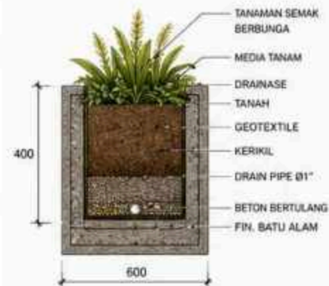
DETAIL PLANTER DASAR SKALA 1 : 20
