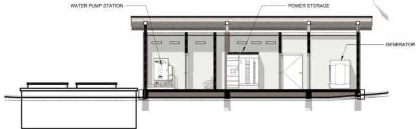
POTONGAN A BANGUNAN KONTROL UTILITAS 1 : 200
