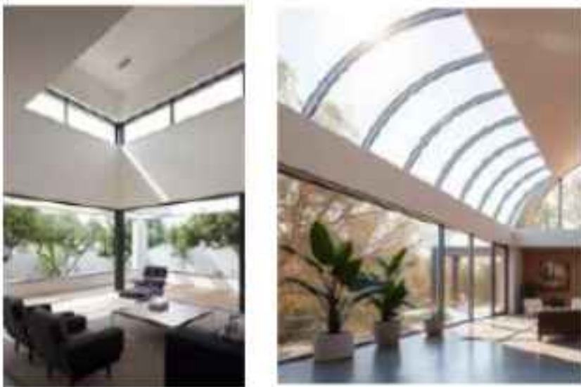
Pencahayaan alami dari clerestory window dan skylight.
