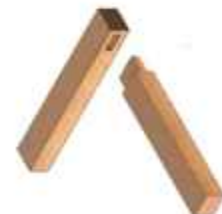
Menggunakan sambungan kayu tenon & mortise joint
