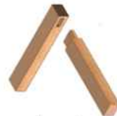
Menggunakan sambungan kayu tenon & mortise joint
