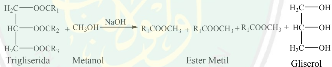
Gambar 2.1 Reaksi transesterifikasi pada trigliserida (Corro dkk, 2012)
