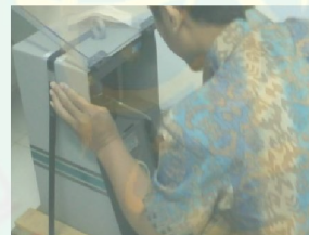
Ditekan serbuk \text{TiO}_2 dengan daya tekan 10 ton
