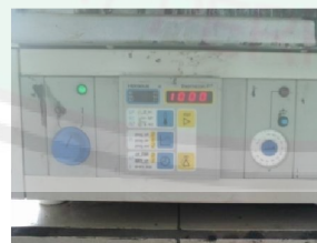
Pelet \text{TiO}_2 di panaskan dalam tanur pada suhu 1000\text{ }^\circ\text{C} selama 540 menit
