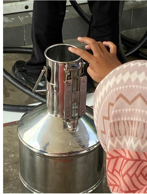
Segel Tera Pompa Ukur BBM dan Bejana Ukur Standar 20 Liter
