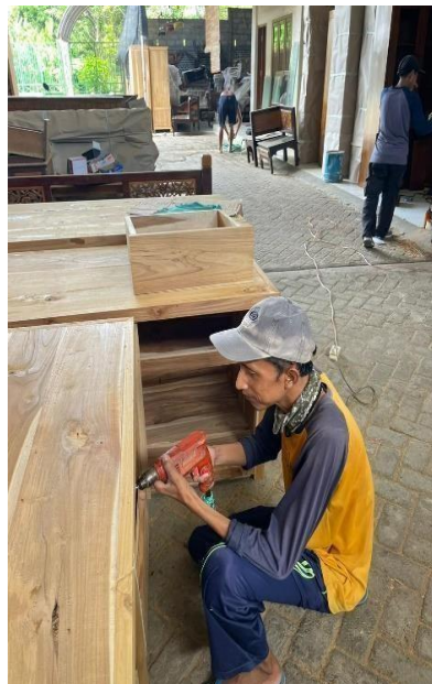
Gambar 1. Penggunaan alat yang tidak layak untuk digunakan (terdapat lilitan tali rafia pada kabel alat yang digunakan )
