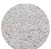
Material jalan pada perancangan menggunakan beton berpori sehingga memudahkan air untuk terserap ke tanah.
