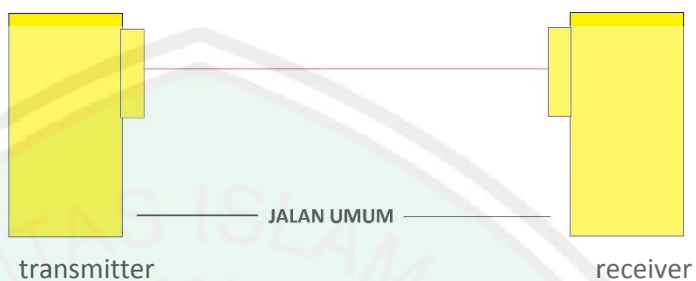
Gambar 3.3. desain pemasangan counter
