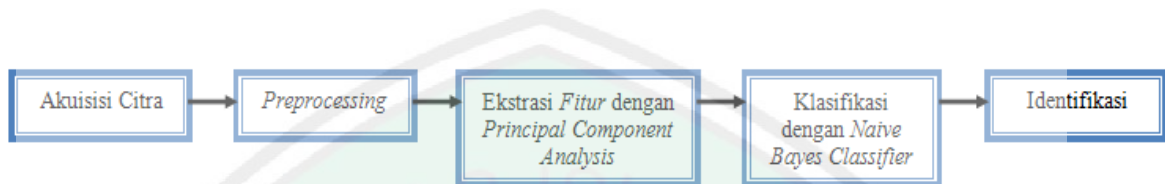
Gambar 3.13 Blok Diagram Proses Secara Umum Sistem Identifikasi Sidik Jari Menggunakan Kombinasi Metode Principal Component Analysis dan Naive Bayes Classifier
