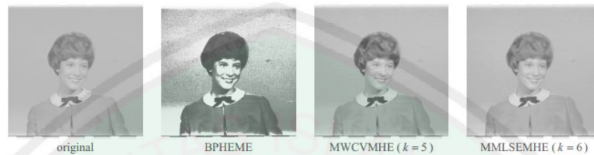
Gambar 2.3. Hasil percobaan a). Gambar original; b). Histogram Equalization c). Multi-histogram Equalization dengan k=5 ; d). Multi-Histogram Equalization dengan k=6 . (sumber: David.2007)
