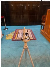
Gambar 1.6 Pengukuran Arah Kiblat di Masjid Raden Patah Universitas Brawijaya
