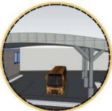
Sisi barat pada bangunan dibuat menjadi area menurunkan penumpang ke area bangunan utama sehingga memiliki banyak bukaan, untuk meminimalisir hal tsb maka dibuat atap dengan sosoran
