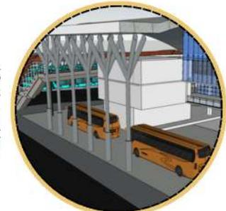
Pada lantai 2 bangunan utama terminal terdapat Sky Bridge sebagai penghubung antara ruang tunggu penumpang dan terminal keberangkatan, pada bagian bawah sky bridge sebagai sirkulasi bus yang menunjukkan prinsip **Transparency, Layering and movement** pada bangunan
