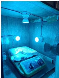
**Gambar 3. 1** Alat fotoreaktor
