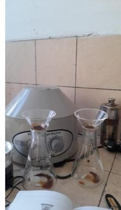
difilter menggunakan filter membran 0,2 µm
