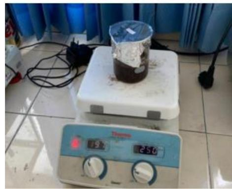
Selama dua jam dengan suhu 200°C, campuran dengan mixer 250 rpm.
