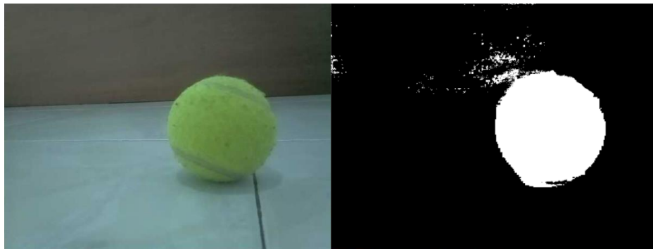
Gambar 3. 7 Sebelum dan Setelah Tresholding Warna
