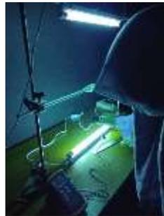
Pengukuran intensitas lampu UV – C
