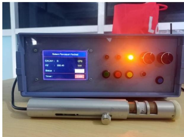
**Gambar 4. 11** Hardware Sistem Pencacah
