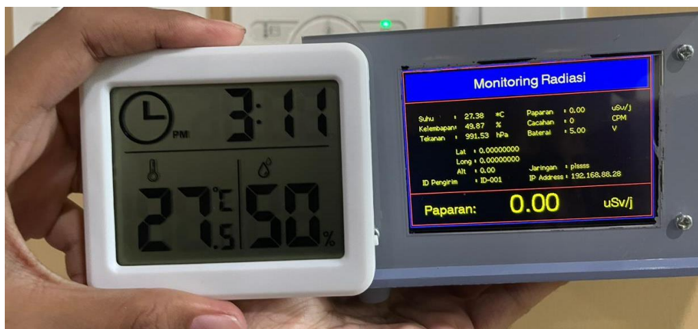
Gambar 4. 17 Pembuktian Kalibrasi Sensor BME-280 dan Termometer Digital di ruangan bersuhu dingin (berAC)
