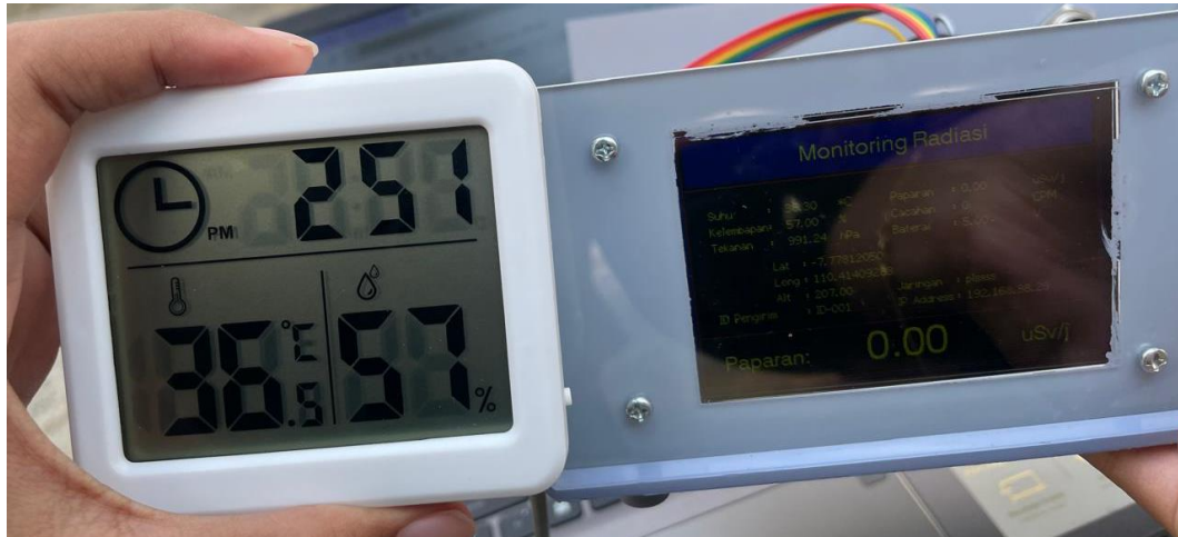
Pembuktian Kalibrasi Sensor BME-280 dan Termometer Digital di Luar Ruangan
