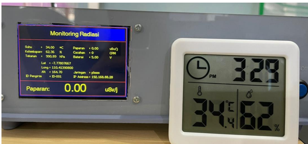
Pembuktian Kalibrasi Sensor BME-280 dan Termometer Digital di ruangan bersuhu normal
