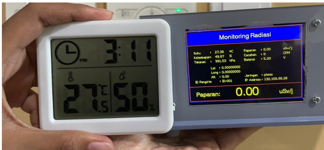
Pembuktian Kalibrasi Sensor BME-280 dan Termometer Digital di ruangan bersuhu dingin (berAC)
