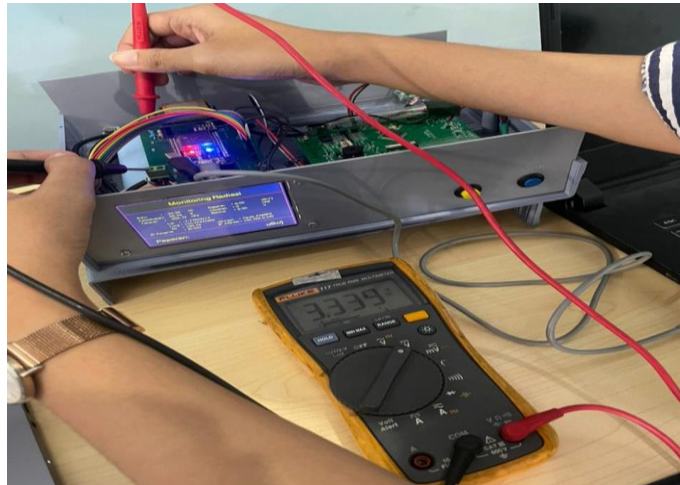
Pembuktian Kalibrasi Tegangan Baterai dengan Voltmeter
