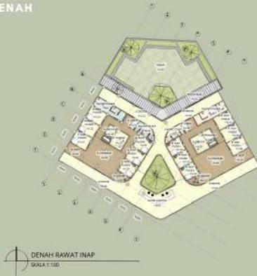
Bangunan rawat inap intermediate (*semi depressed*) dibentuk dengan konsep blok, yang setiap 1 bangunan nya memiliki 2 blok yang disatukan dengan koridor dilengkapi bukaan hijau sebagai zona transisi.
