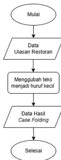
Gambar 3.4 Flowchart tahap *Case Folding*
