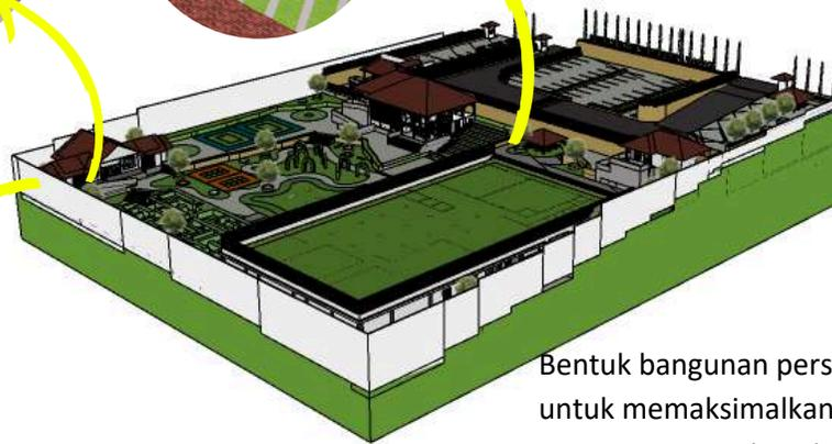
Bentuk mengikuti kontur dengan atap tinggi dan tritisan lebar. pada bangunan tanpa roof top.
