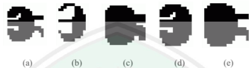
Gambar 2.4 Hasil dari Operasi Morfologi: (a) Original Image (b) Erosion (c) Dilation (d) Opening (e) Closing (Sumber: Steven, W. Smith, 2012)
