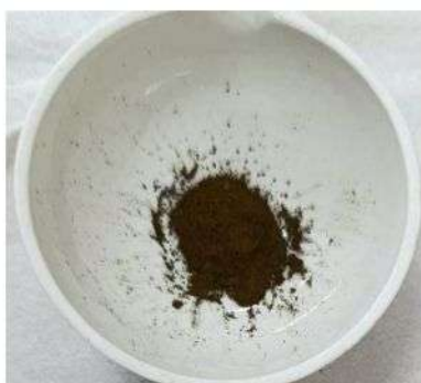
Hasil produk sintesis senyawa kompleks basa Schiff-Cu(II) Ulangan 2
