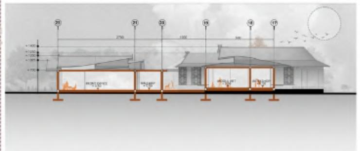
gambar ini menampilkan potongan dementia care centre dengan struktur utama beton bertulang. area terdiri dari front office, hallway, modul art, dan workshop, yang dirancang untuk memfasilitasi aktivitas terapeutik dan kreatif bagi lansia dengan demensia. hallway berfungsi sebagai penghubung utama antar ruang, meningkatkan **manageability** dengan alur sirkulasi yang jelas dan mudah dipahami
