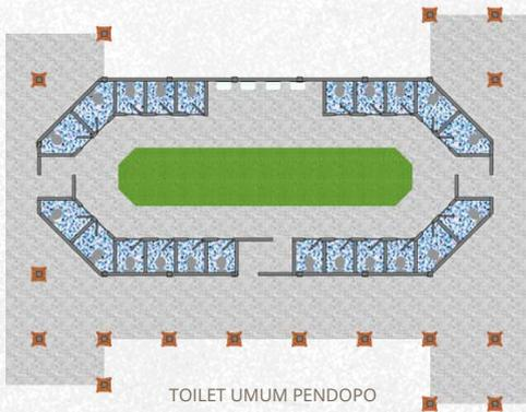
Untuk area pendopo dibuat void yang langsung keluar tanpa atap, sedangkan di area pujasera melalui lubang ventilasi atap kaca
