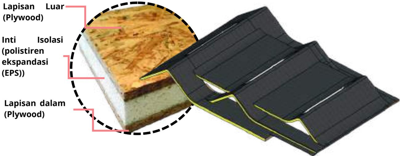
SIP (Structural Insulated Panel for Roof) adalah panel struktural yang terdiri dari dua lapisan material yang mengapit inti isolasi. Dalam konteks atap, SIP sering digunakan untuk memberikan kekuatan struktural sekaligus isolasi termal yang efisien.
