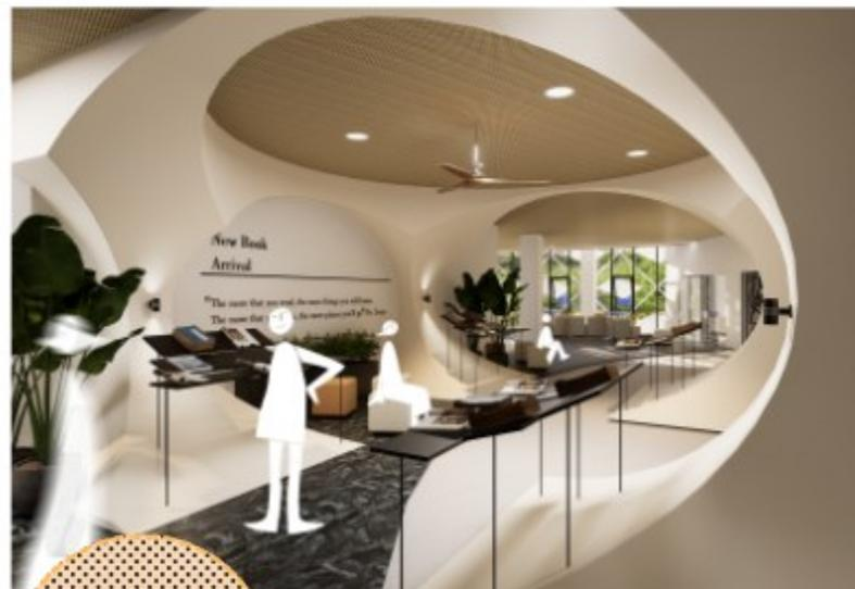
Material perforated ceiling panel ini menggunakan warna kayu untuk memberikan kesan tenang dan nyaman di mata. Selain itu, penggunaan perforated ceiling ini bertujuan untuk **mengurangi frekuensi bunyi dan gema dalam ruangan.**
