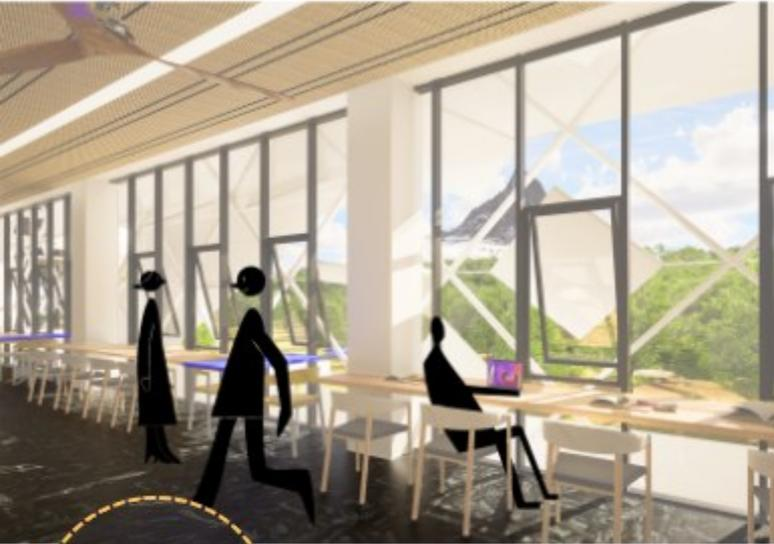
Material keramik motif granit hitam ukuran 60x60 cm diletakkan di area baca. Warna gelap keramik ini berguna untuk **menghindari pantulan berlebih** yang menyebabkan silau (*glare*)
