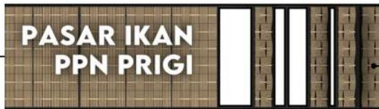
*Secondary skin* pada lantai 2 dengan material bambu yang dianyam dengan motif gelombang air laut. Dilengkapi dengan nama gedung bangunan.
