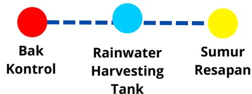
Penyempurnaan utilitas Air hujan untuk stadion ini, Air hujan dari talang air atap menuju ke bak kontrol dan sumur resapan. Lalu menuju ke rainwater harvesting tank untuk dimanfaatkan kembali dan sebagian dialirkan ke saluran kota.
