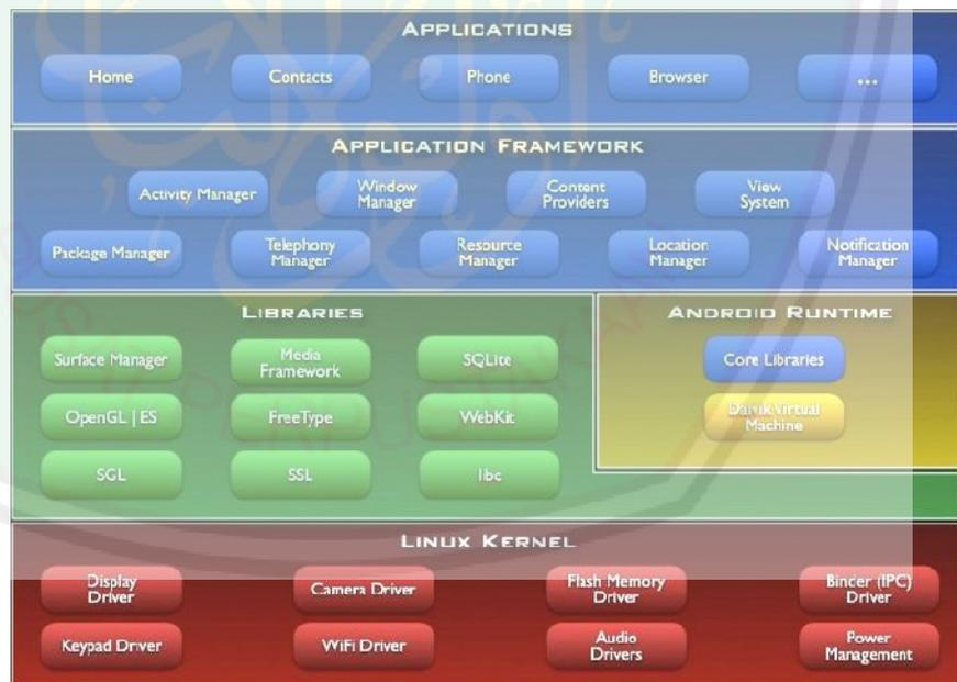
Gambar 1. Diagram komponen utama android
